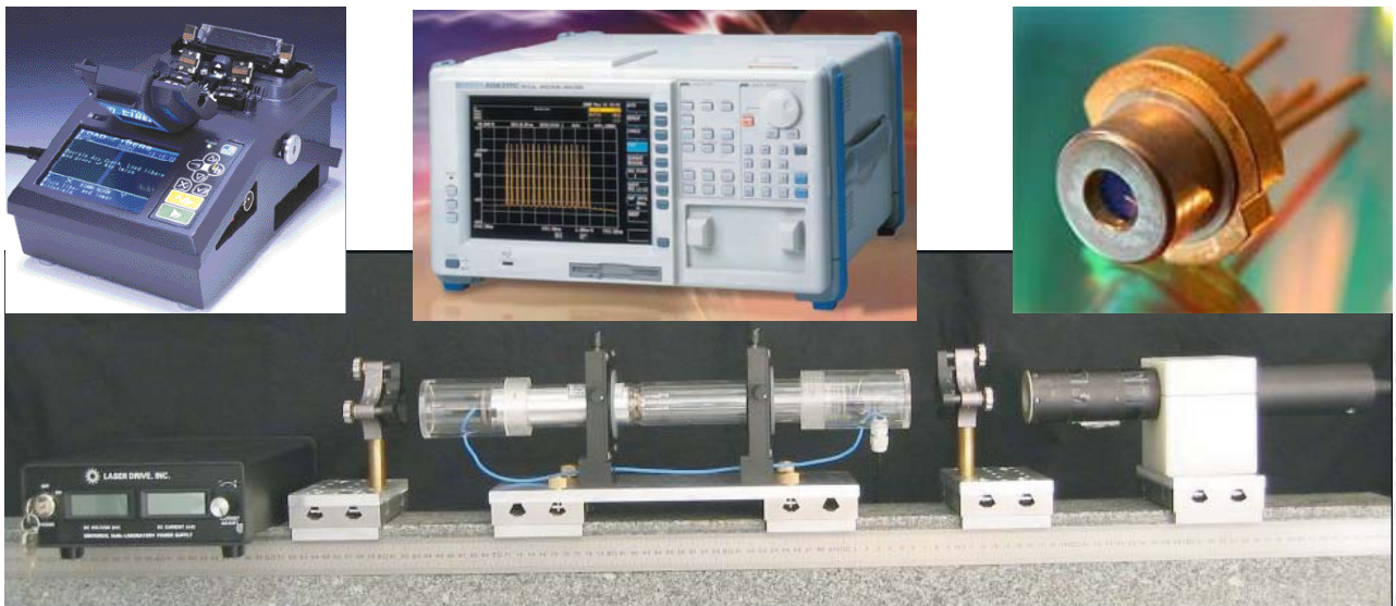
Oben v.l.n.r.: Fusionsspleier fur SM-Glasfasern, Optischer Spektralanalysator, Laserdiode Unten: Experimenteller Helium-Neon-Laser mit Hochspannungsnetzteil und externem Resonator
