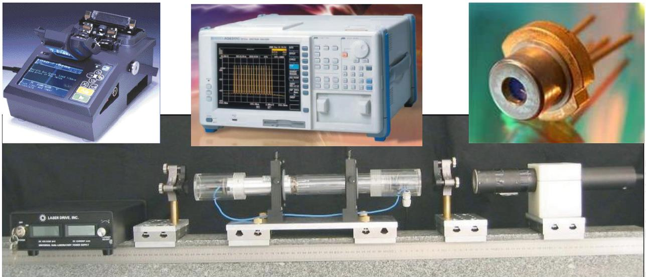
Oben v.l.n.r.: Fusionsplicer für SM-Glasfasern, Optischer Spektralanalysator, Laserdiode
